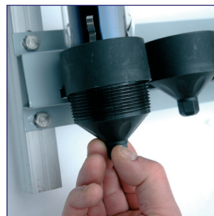
14. Nun schrauben Sie den Boden wieder in den Röhrenhalter ohne die Röhre unter Spannung zu setzen.
