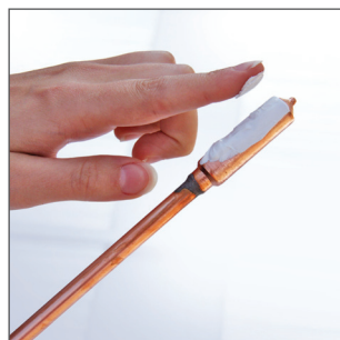
9. Verteilen Sie reichlich Kupferpaste auf den Kondensator
